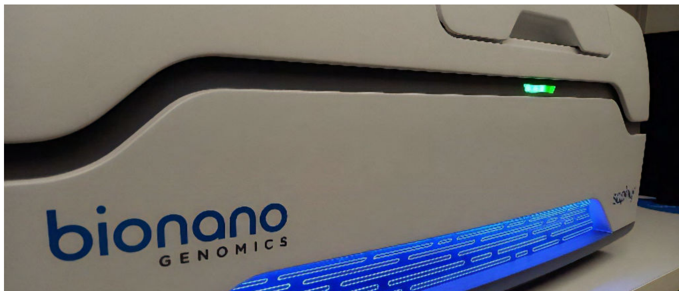
▼ Foto 2. Met het Bionano Saphyr toestel kan de dienst Laboratoriumgeneeskunde chromosomen in humane cellen bestuderen
